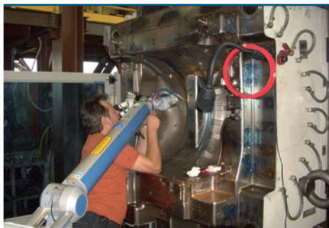
Mobiles Reparaturschweißen in der Maschine an einer Spritzgussform (Foto: Jutz Lasertechnik)
