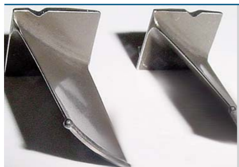
Ausbesserung beschädigter Konturbereiche bei Turbinenschaukeln (Foto: L&A Lasertechnik, Radebeul)
