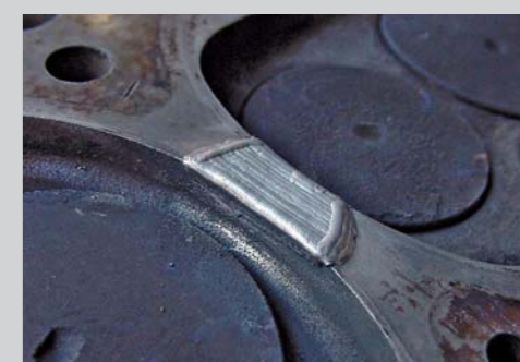
Reparatur eines wassergekühlten Zylinderkopfes aus Aluminium (Foto: L&A Lasertechnik, Radebeul)
