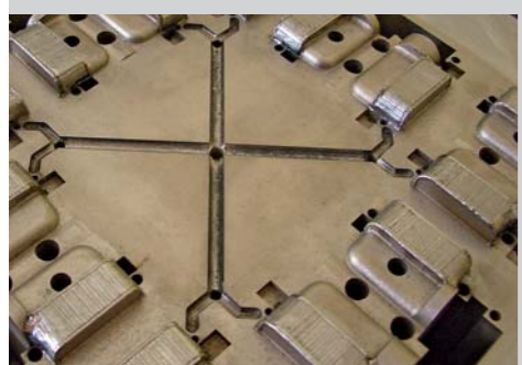
Konturänderung eines 8-fach Gießwerkzeugs durch mehrlagiges Auftragsschweißen (Foto: Jutz Lasertechnik GmbH, Wien)
