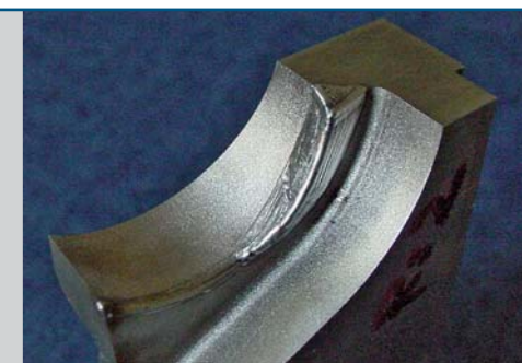
Änderung der Kontur 1.2767 (Foto: L&A Lasertechnik, Radebeul)
