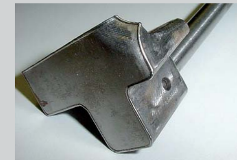
Auftragsschweißen an verschlissenen Dichtkanten (Foto: L&A Lasertechnik, Radebeul)
