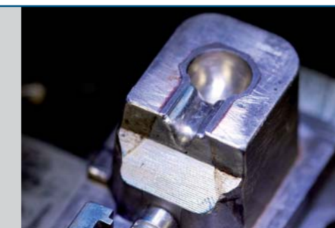
Formeinsatz für eine Spritzgießform (Foto: Grübel KG, Tabarz)
